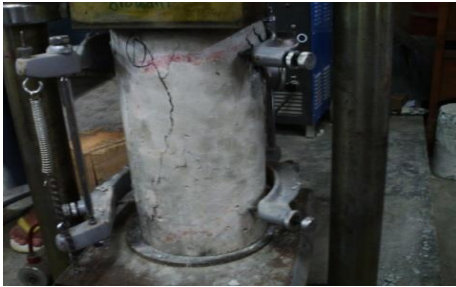
Gambar 7. Benda uji setelah pembakaran suhu 400°C.
