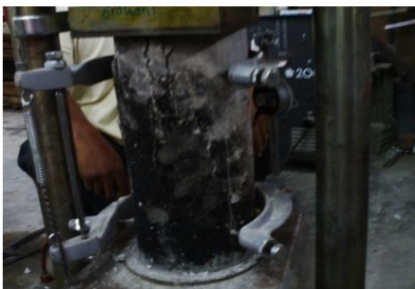
Gambar 8. Benda uji setelah pembakaran suhu 800°C.
