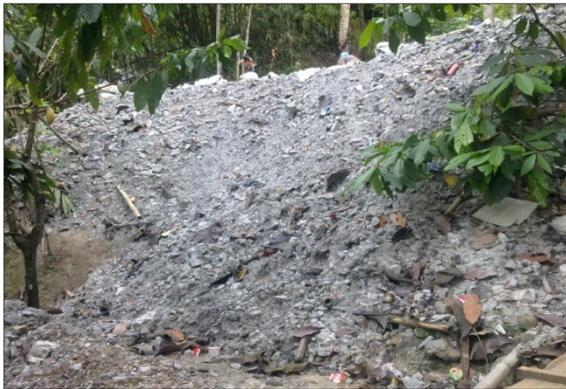
Gambar 2. Timbunan batuan samping (*disposal waste*) yang dianggap tidak mengandung bijih
