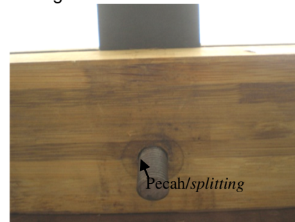
Gambar 12. Tampak samping model kegagalan uji tahanan lateral tegak lurus arah serat
