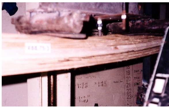
d) Kerusakan balok RBB.75
