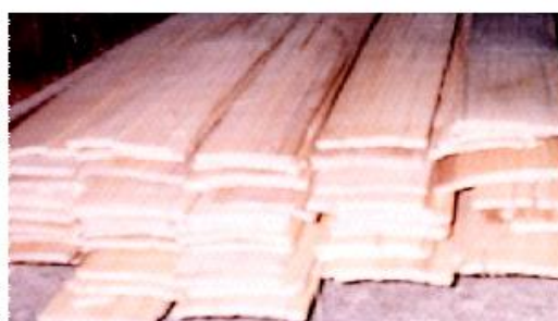
Gambar-2. Pembuatan bahan bambu apus berupa galar
