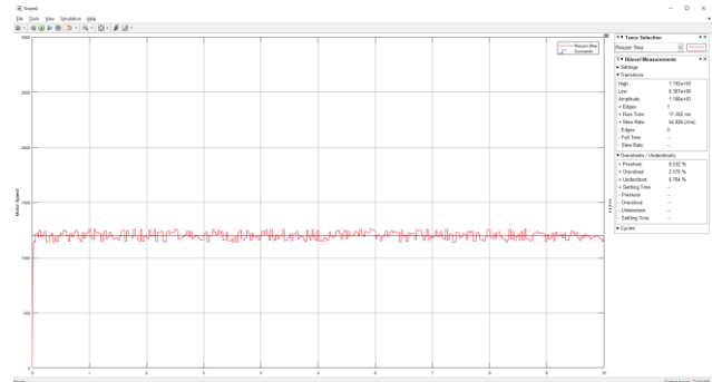
Gambar 16 Respon Sistem menggunakan FLC dengan sampling time 0.03s Set Point 1200rpm
