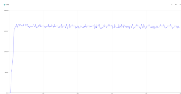
Gambar 26 Respon Sistem Menggunakan FLC Set Point 1600rpm
