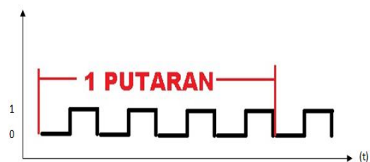
Gambar-9. Gambaran sinyal roda encoder
