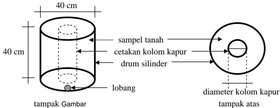
Gambar 1. Tempat pengujian
