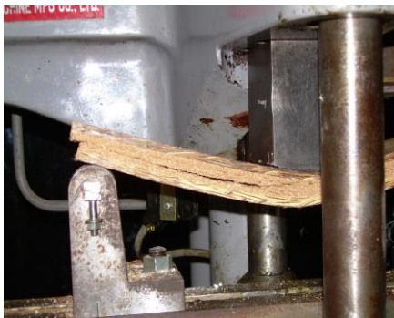
a) Rusak geser pada garis netral
