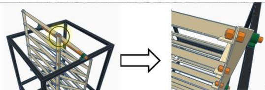
**Gambar-9.** Mekanisme Rak Penetas Telur Pada Mesin penetas E-Tas.
