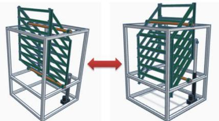
**Gambar-11.** Perubahan Posisi Rak yang Disebabkan Aktuator Linier Pada Rak Mesin penetas E-Tas.
