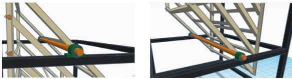
**Gambar-10.** Tumpuan Rak Bagian Atas dan Bawah Pada Rak Mesin penetas E-Tas.
